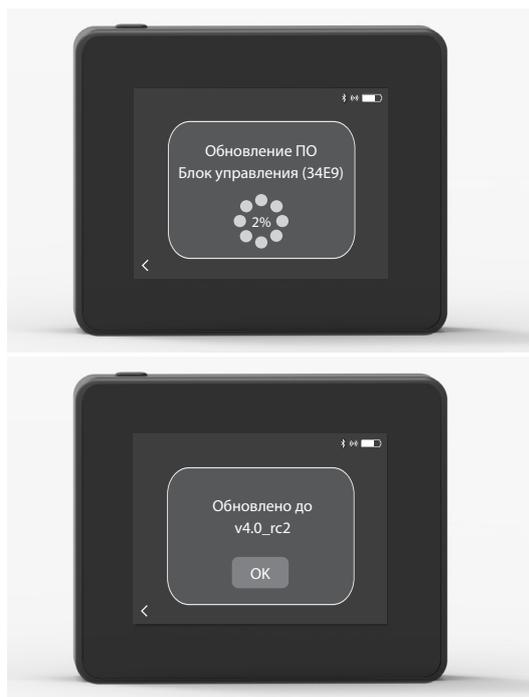
Как только процесс передачи обновления на блок управления будет завершен, процесс обновления блока управления начнется автоматически (это займет примерно минуту). После этого панель управления готова к использованию.
